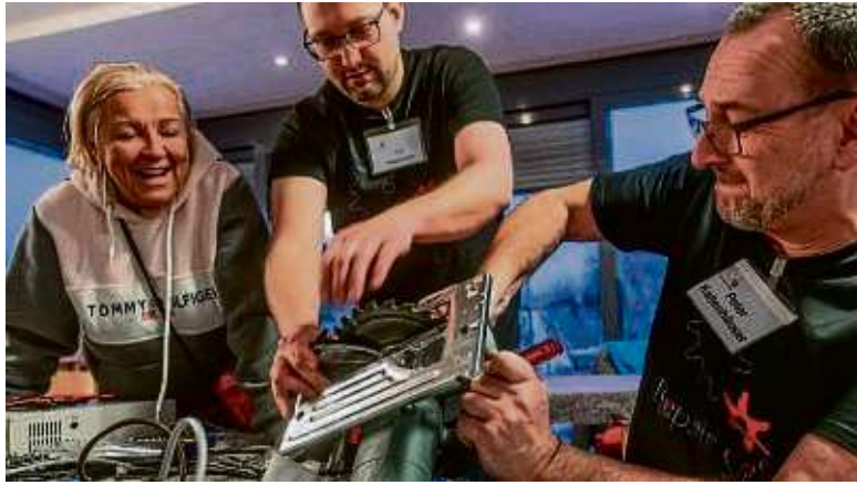
Zu viel Verschleiß an zu vielen Stellen: Die Tüftler des Repair-Cafés Tim Hegemann (Mitte) und Peter Kaltenhäuser kommen zu der Erkenntnis, dass die Kreissäge nicht mehr zu retten ist.
