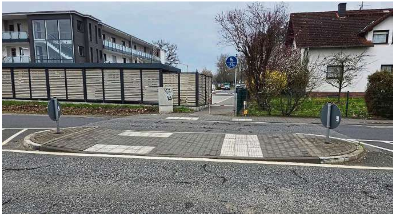
Durchgang zur Aschaffener Straße mit Drängelgitter: tückisch, weil schwer einsehbar.
