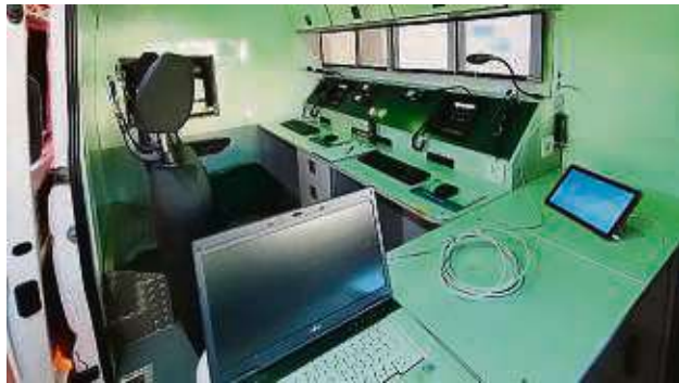
Blick ins Innere: Das ELW1 ist mit modernster EDV- und Funktechnik ausgestattet und bietet vier Arbeitsplätze.
