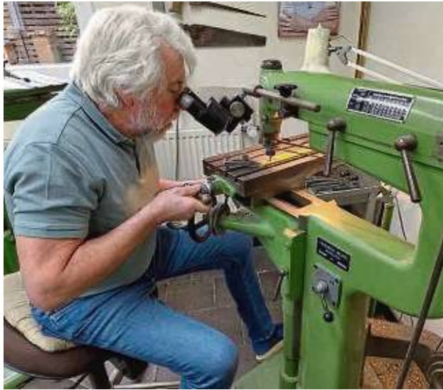
In seiner Erlenseer Werkstatt gestaltet der Graveurmeister mithilfe der Fräsmaschine ein Messing-Plättchen: die Vorlage für einen Buchrücken.
