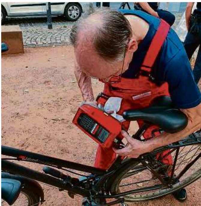
Bei der Fahrradcodierung wird eine Nummer in den Fahrradrahmen eingepreßt. Archivfoto: sh
