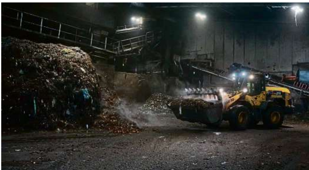
In der Rhein Main Biokompostanlage schaufelt ein Radlader den Biomüll auf, um ihn zum Zerkleinern zu transportieren. Foto: sh
